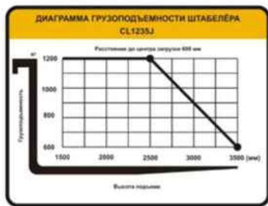
Рисунок. 4. Диаграмма грузоподъемности штабелера.
