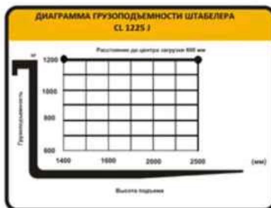
Рисунок. 4. Диаграмма грузоподъемности штабелера.
